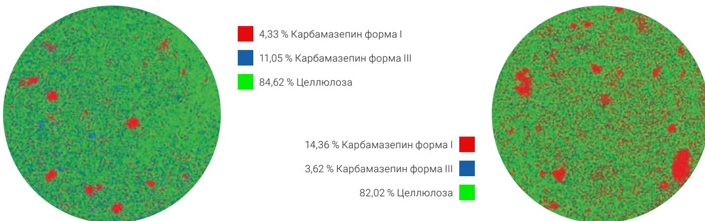
**Рис. 2.** Изображение для классификации таблетки 13 мм в диаметре отражает распределение форм I и III карбамазепина и целлюлозы при размере пикселя 10 мкм. При разрешающей способности с размером пикселя 10 мкм для классификационного анализа всей пробы таблетки диаметром 13 мм требуется всего 27 минут
